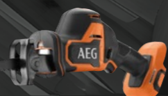
SCIE SABRE 18V Batterie (non fournie): 18V Course: 22 mm Vitesse: 0 à 3 200 cps/min Poids sans batterie: 1,8 kg Réf: 4935479662 (1)
