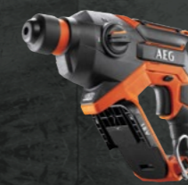
PERFORATEUR SDS+ 18V Batterie (non fournie): 18V Énergie de frappe: 1,5 J Vitesse: 0 à 1 300 tr/min Frappe: 0 à 5 500 cps/min Poids sans batterie: 2,5 kg Réf: 4935464984 (1)
